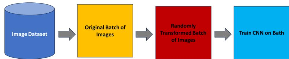
Figure 1. On-The-Fly Augmentation Approach.
