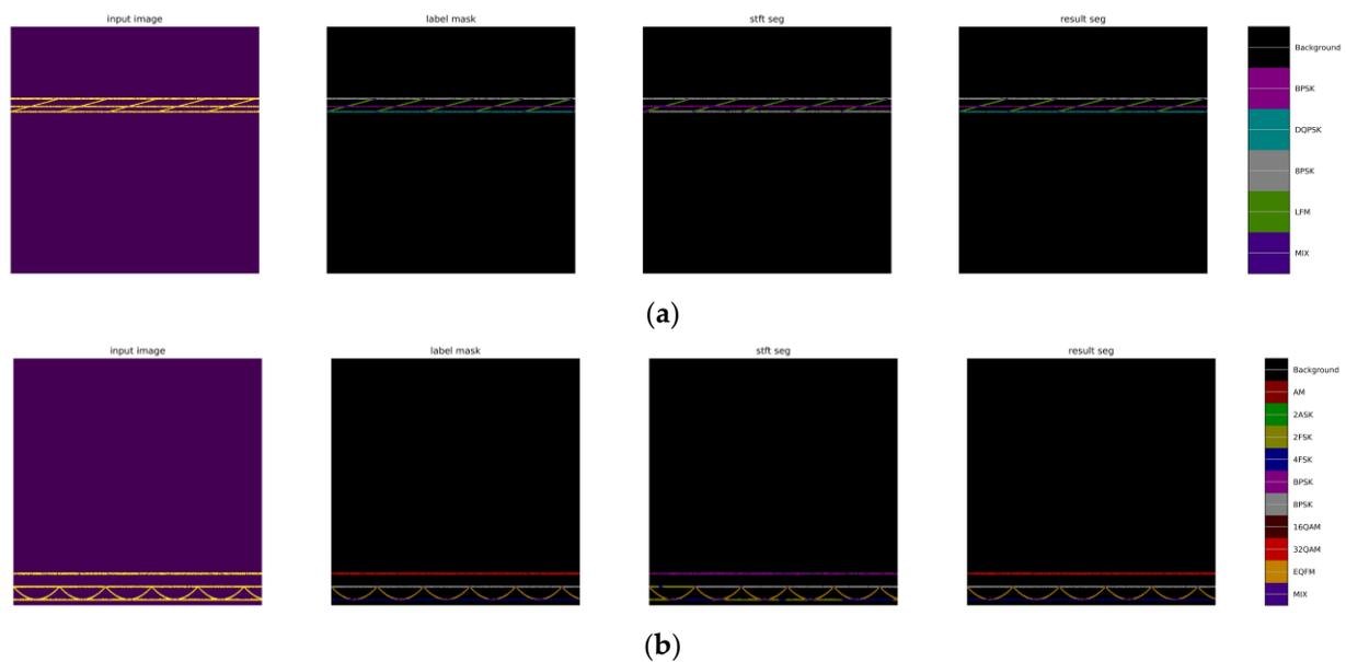
**Figure 19.** Examples of the recognition results of the TRMM method ((a): BPSK + DQPSK + 8PSK + EQFM; (b): 8PSK + 32QAM + 4FSK + EQFM).
