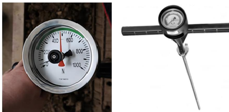
**Figure 13.** Hand penetrometer Eijkelkamp.
