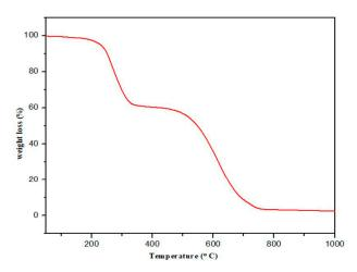
Figure 3. TGA of  $(C_6H_{10}N_2)_4[CdBr_6][CdBr_4]_2$ .
