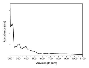
**Figure 4.** K-M absorption spectrum of  $(C_6H_{10}N_2)_4[CdBr_6][CdBr_4]_2$ .
