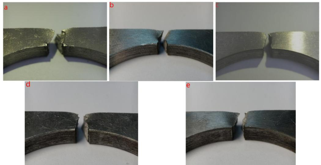
**Figure 8.** Macrograph of side and fracture after splitting of (a) 0  $\mu\text{m}$ , (b) 6  $\mu\text{m}$ , (c) 15  $\mu\text{m}$ , (d) 25  $\mu\text{m}$ , (e) 30  $\mu\text{m}$ .
