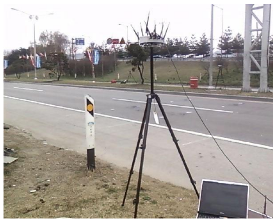
(d) T-Sink node capable of covering four lanes.
