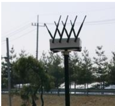
(d) T-Sink node capable of covering four lanes.
