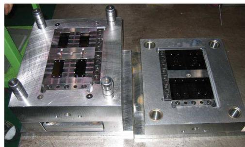
(d) Assembled mold set for test injection.
