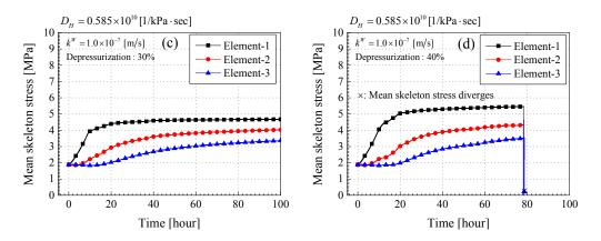
**Figure 11.** Time profiles of the mean skeleton stress  $\sigma'_m$  (MPa). (a) Case-4-30; (b) Case-4-40; (c) Case-7-30; (d) Case-7-40.
