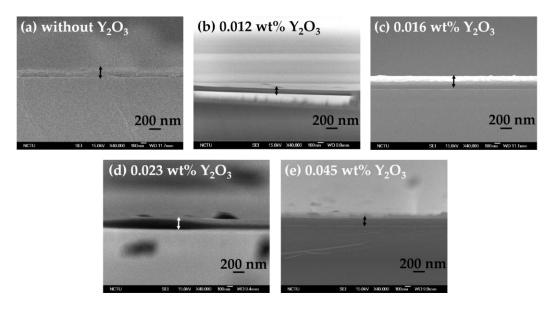
Figure 5. Cross-section images of the blended  $Y_2O_3$ /chitosan thin films: (a) Without  $Y_2O_3$ ; (b) 0.012 wt %; (c) 0.016 wt %; (d) 0.023 wt %; and (e) 0.045 wt %.
