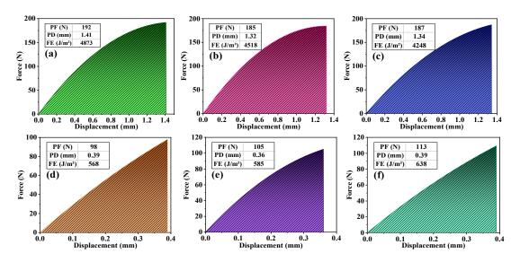
**Figure 12.** DTT results of all binders ((a) SBS MAB, (b) SBS + 3 wt% LDH MAB, (c) SBS + 4 wt% LDH MAB; (d) SBS MAB-UV, (e) SBS + 3 wt% LDH MAB-UV, (f) SBS + 4 wt% LDH MAB-UV).
