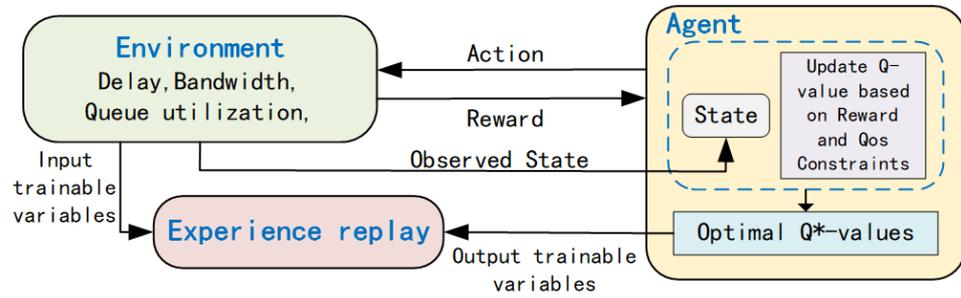
Figure 5. Architecture diagram of DQN-LLRA.
