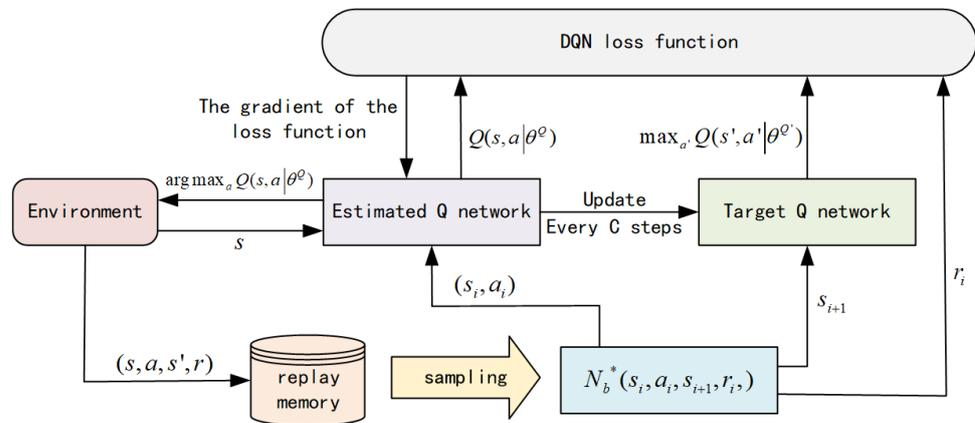
Figure 9. The flowchart of the DQN algorithm.
