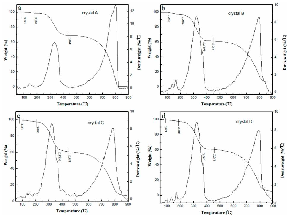
Figure 4. TG/DTG thermograms for the crystals. (a) crystal A; (b) crystal B; (c) crystal C; (d) crystal D.
