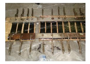
Figure 3. CFRP Coupon.
