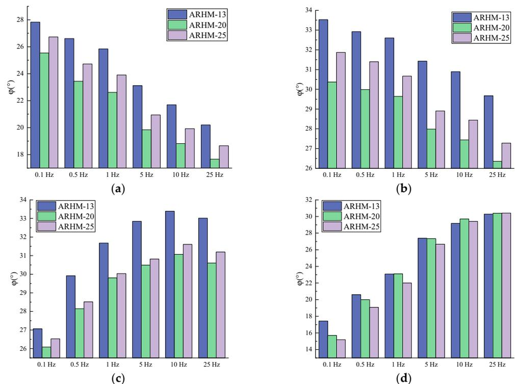
**Figure 17.** Relationship between asphalt mixture type and phase angle: (a)  $T = 15^\circ\text{C}$ ; (b)  $T = 30^\circ\text{C}$ ; (c)  $T = 45^\circ\text{C}$ ; (d)  $T = 60^\circ\text{C}$ .
