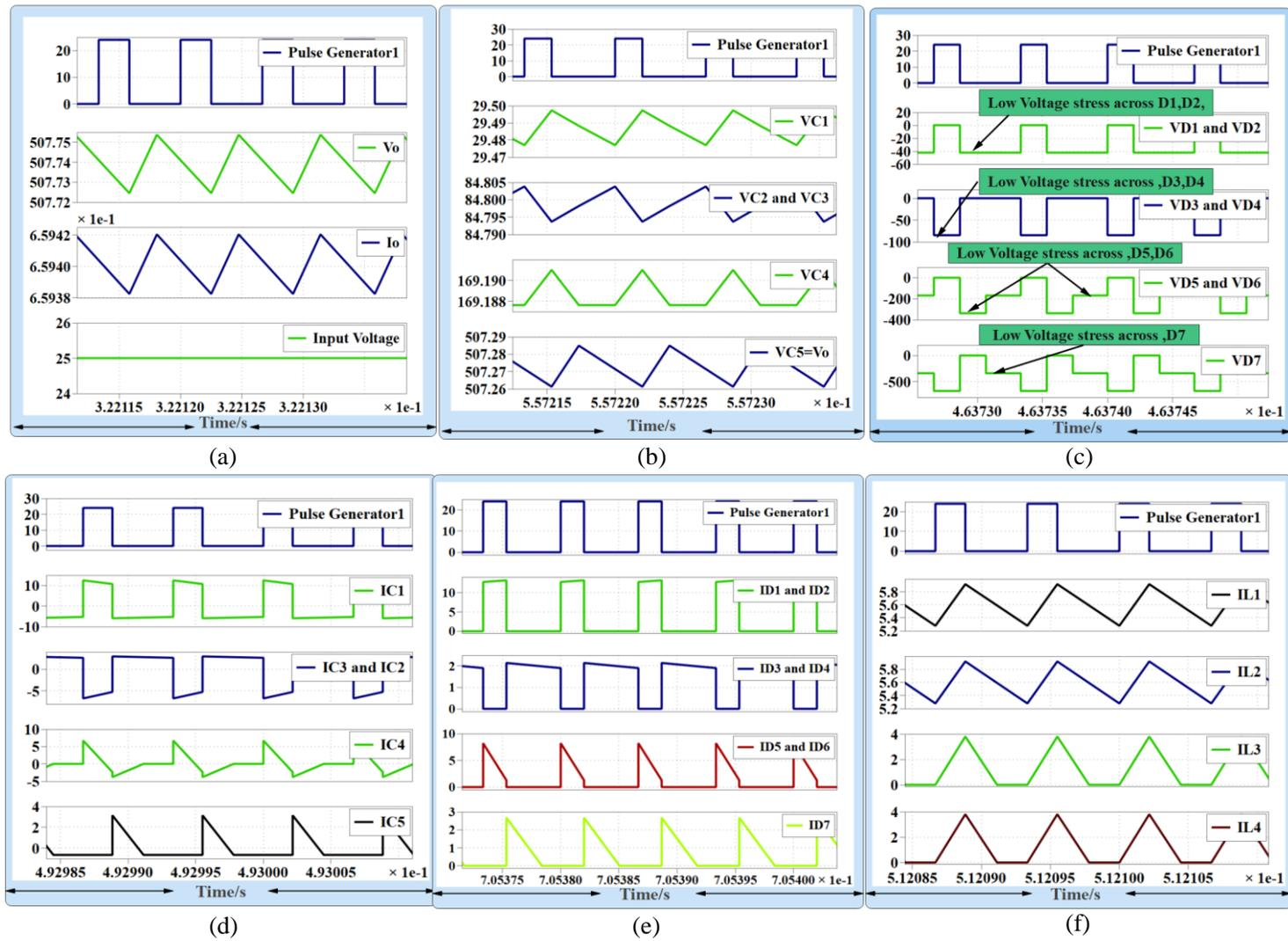
**Figure 10.** (a)  $V_o$ ,  $I_o$ ,  $V_g$ ; (b)  $V_{C1}$ ,  $V_{C2}$ ,  $V_{C3}$ ,  $V_{C4}$ ,  $V_{C5}$ ; (c)  $V_{D1}$ ,  $V_{D2}$ ,  $V_{D3}$ ,  $V_{D4}$ ,  $V_{D5}$ ,  $V_{D6}$ ,  $V_{D7}$ ; (d)  $I_{C1}$ ,  $I_{C2}$ ,  $I_{C3}$ ,  $I_{C4}$ ,  $I_{C5}$ ; (e)  $I_{D1}$ ,  $I_{D2}$ ,  $I_{D3}$ ,  $I_{D4}$ ,  $I_{D5}$ ,  $I_{D6}$ ,  $I_{D7}$ ; (f)  $I_{L1}$ ,  $I_{L2}$ ,  $I_{L3}$ ,  $I_{L4}$
