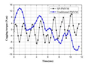
Figure 14. Cogging torque.
