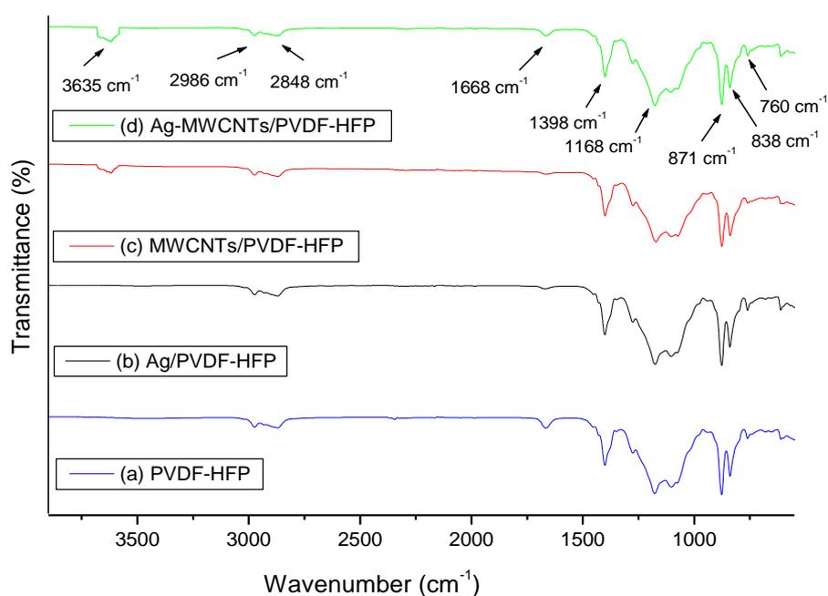
**Figure 4.** Fourier transform infrared (FTIR) spectra of (a) PVDF-HFP, (b) Ag/PVDF-HFP, (c) MWCNTs/PVDF-HFP, and (d) Ag-MWCNTs/PVDF-HFP.
