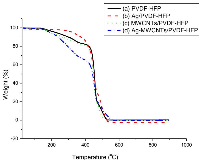
**Figure 3.** Thermogravimetric analysis (TGA) of (a) PVDF-HFP, (b) Ag/PVDF-HFP, (c) MWCNTs/PVDF-HFP (d) Ag-MWCNTs/PVDF-HFP.
