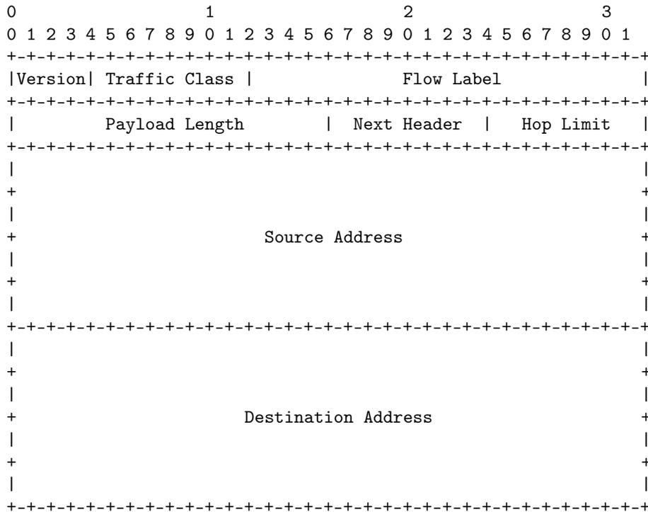
Figure 12. IPv6 header format.
