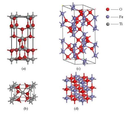
Figure 10. The crystal structures of (a) anatase nano- $TiO_2$  (b) rutile nano- $TiO_2$  (c)  $Fe_2O_3$  and (d) FeO.
