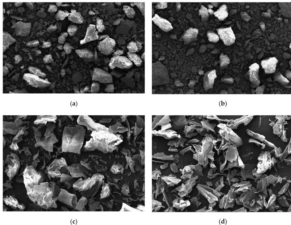
**Figure 3.** Micro surface texture morphologies of the mineral filler particles. (a) Limestone filler; (b) granite filler; (c) coconut peat filler; (d) bagasse filler.
