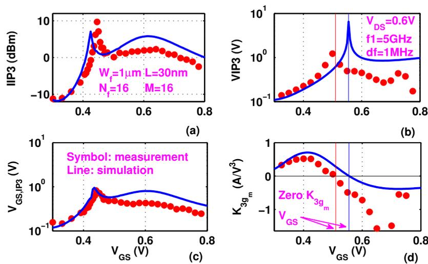
**Figure 6.** (a)  $IIP3$  (b)  $VIP3$  (c)  $V_{GS,IP3}$  and (d)  $K_{3gm}$  as a function of  $V_{GS}$  at  $V_{DS} = 0.6$  V.
