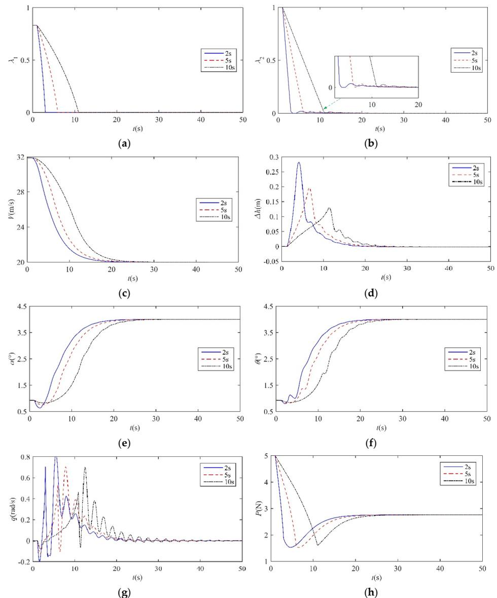
**Figure 9.** The dynamic responses of the transition process from dashing configuration to loitering configuration. (a)  $\lambda_1$ ; (b)  $\lambda_2$ ; (c)  $V$ ; (d)  $\Delta h$ ; (e)  $\alpha$ ; (f)  $\theta$ ; (g)  $q$ ; (h)  $P$ .
