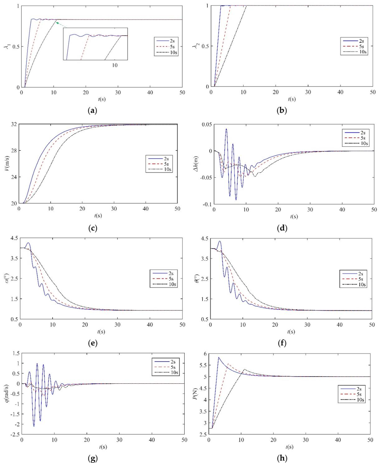
**Figure 8.** The dynamic responses of the transition process from loitering configuration to dashing configuration. (a)  $\lambda_1$ ; (b)  $\lambda_2$ ; (c)  $V$ ; (d)  $\Delta h$ ; (e)  $\alpha$ ; (f)  $\theta$ ; (g)  $q$ ; (h)  $P$ .
