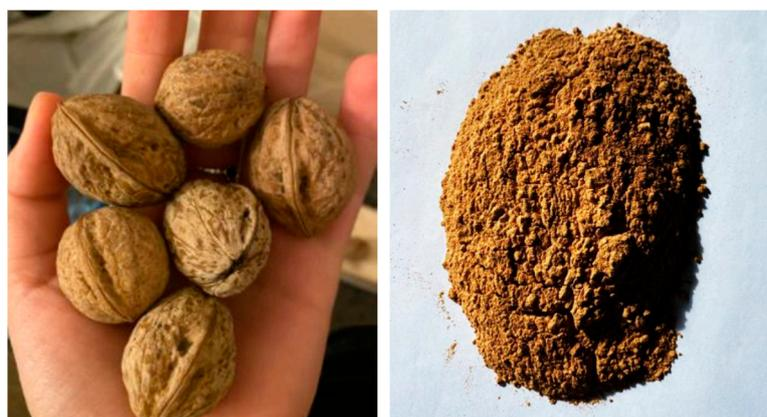
**Figure 19.** Walnut shell before and after fine grinding [105]. Reproduced with permission from Daria Rozian “Influența ligninei asupra rezistenței la compresiune a betonului și asupra aderenței armăturii în beton” (Master Dissertation), advisor: T.-N. Toader, UTCN, 2022.
