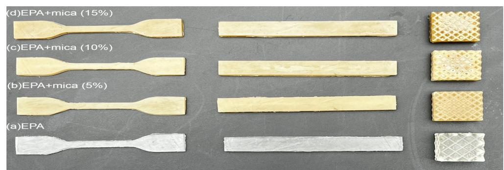
**Figure 13.** The 3D-printed samples images of (a) EPA, (b) 5% EPA/mica, (c) 10% EPA/mica, (d) 15% EPA/mica.
