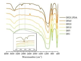
**Figure 1.** FT-IR spectra for DF1, DF5, DF10, DF20, DF40 and DF20\_PDA. Inset: magnification of 2700–3200 cm<sup>-1</sup> spectral region.
