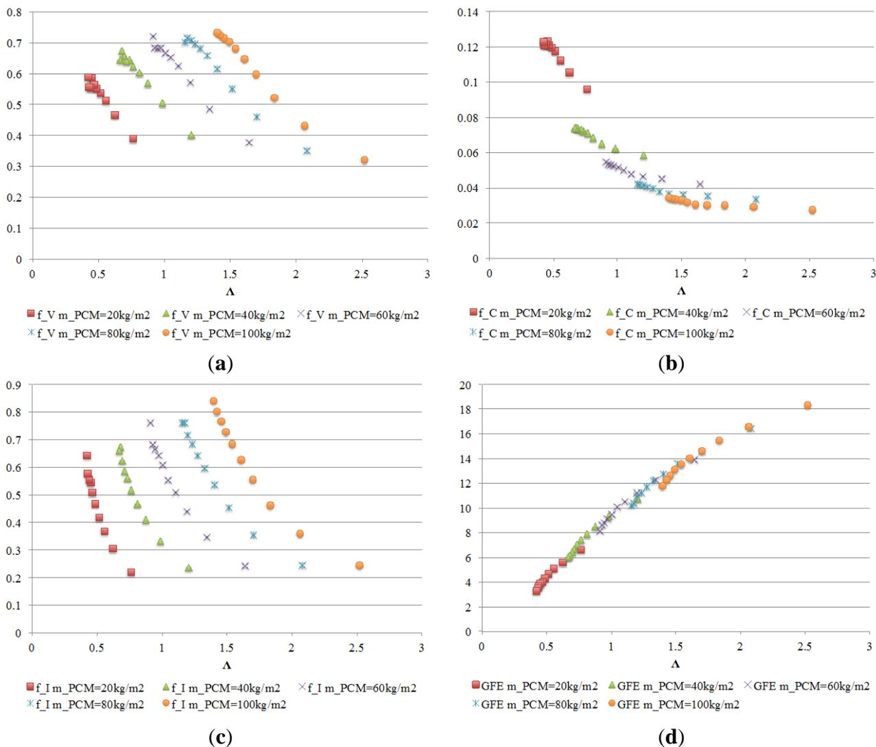
Figure 9. Indicators for different amounts of PCM: (a)  $f_v$ ; (b)  $f_c$ ; (c)  $f_i$ ; (d)  $GFE$ .
