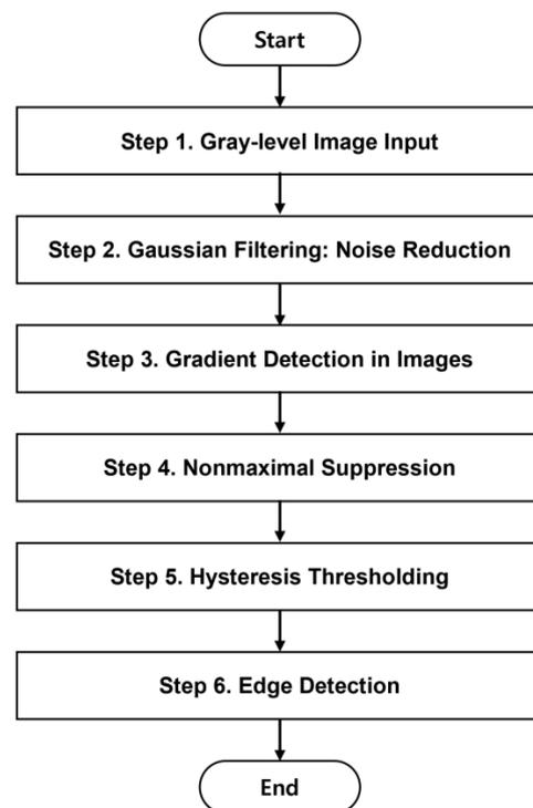
**Canny Edge Detection Algorithm**
