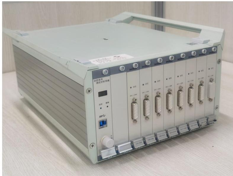
Figure 27. DH5922D dynamic signal tester.
