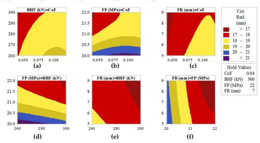
**Figure 12.** Contour Plots—effect of two parameters on Corner Radius. (a) BHF  $\times$  CoF, (b) FP  $\times$  CoF, (c) FR  $\times$  CoF, (d) FP  $\times$  BHF, (e) FR  $\times$  BHF, (f) FR  $\times$  FP.
