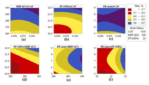
**Figure 11.** Contour Plots—effect of two parameters on Thinning Percentage. (a) BHF  $\times$  CoF, (b) FP  $\times$  CoF, (c) FR  $\times$  CoF, (d) FP  $\times$  BHF, (e) FR  $\times$  BHF, (f) FR  $\times$  FP.
