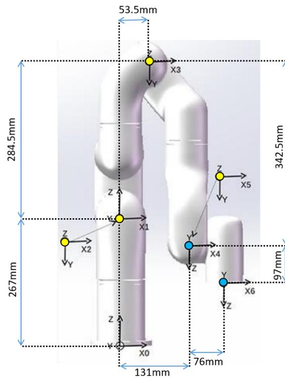
**Figure 3.** Modified DH parameters of the robot.
